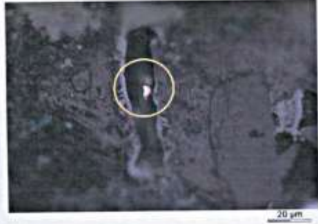
Lokale, metallische, gelbliche Partikel Aufnahme n Lichtmikroskop geätzt in 3%iger, alkoholischer HNO 3 (Nital)
